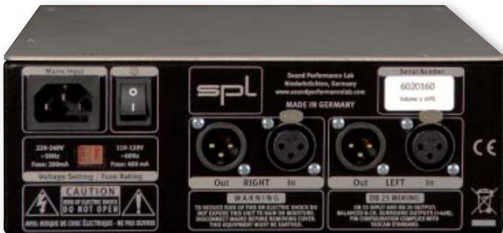
Die Rückseite des Volume 2 enthält sowohl die XLR-Ein- und Ausgänge, als auch den Netzschalter, nebst Buchse. Irreführend sind die Beschriftungen links und rechts vom roten Spannungsumschalter.
