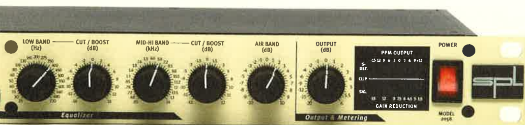
Der beleuchtete Netzschalter befindet sich erfreulicherweise auf der Frontplatte des Gerätes.
