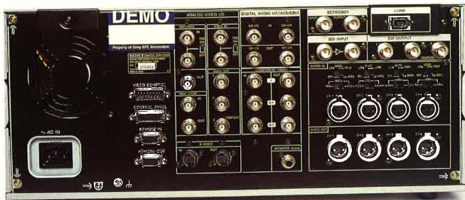
DSR-2000 är försedd med ut- och ingångar för SDI, SDTI (QSDI), AES/EBU, i.LINK (DV in/ut), SDTI samt ClipLink för snabbare digitalisering ihop med exempelvis EditStation ES-7.
