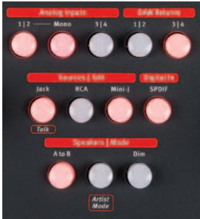
Die Schalter melden ihren Schaltzustand mit einer roten oder orangenen LED zurück, wodurch die Signalwege gut verdeutlicht werden
