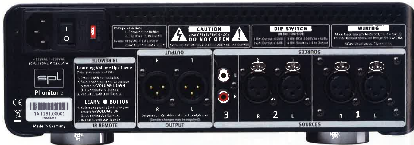
Der Phonitor 2 bietet zwei symmetrische XLR-Eingänge an, die auf der Vorderseite umschaltbar sind und einen RCA-Eingang. Der XLR-Ausgang unterstützt zwei Betriebsarten, um symmetrische Kopfhörer oder Aktivlautsprecher anzusteuern
