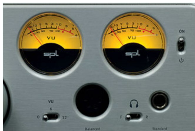
Le uscite per cuffia sono del genere bilanciato e sbilanciato. Bellissimi i VU-meter con lo sfondo giallo. La sensibilità è impostabile tramite commutatore.
