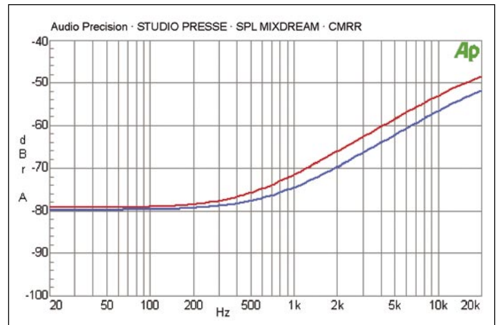
Diagramm 4: Unsymmetriedämpfung zweier Eingangskanäle
