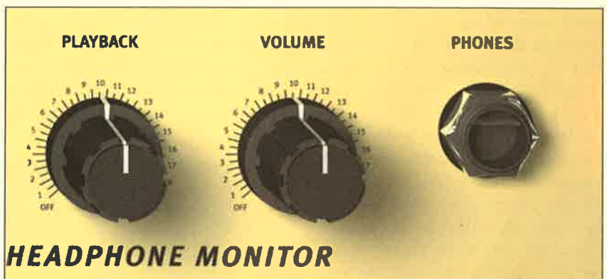
Mit dem integrierten Kofhörerverstärker umgeht SPL gerissen etwaige Latenzprobleme des Audiokarten-Monitorings.
