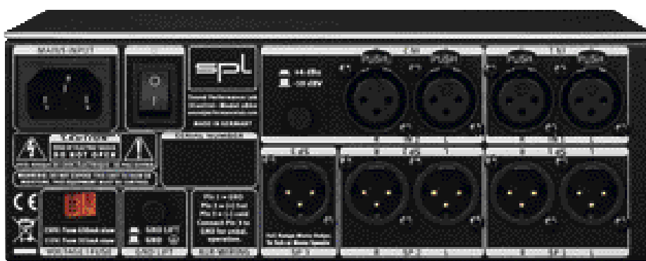
Auf der Rückseite des 2Control befinden sich vier XLR-Eingänge für Quellen – wie beispielsweise den DAW-Mix – und fünf XLR-Ausgänge für Lautsprechersysteme.
